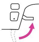
1. Schalten Sie den Netzschalter auf On ("I") ein. Heben Sie den Nähfußheber an.
