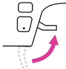
Bringen Sie den Netzschalter in die Aus-Position ("O"). Heben Sie den Nähfußheber an.
