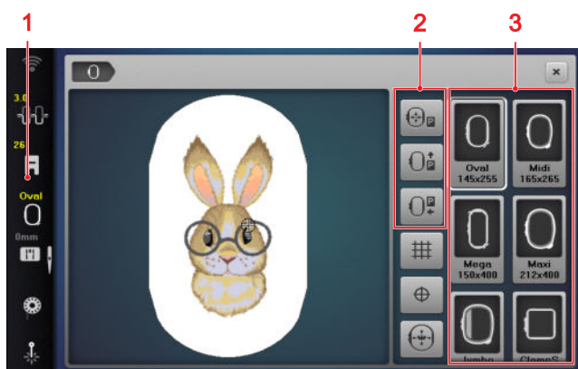
1 Montierter Stickrahmen 2 Stickrahmenverschiebung 3 Stickrahmenauswahl
